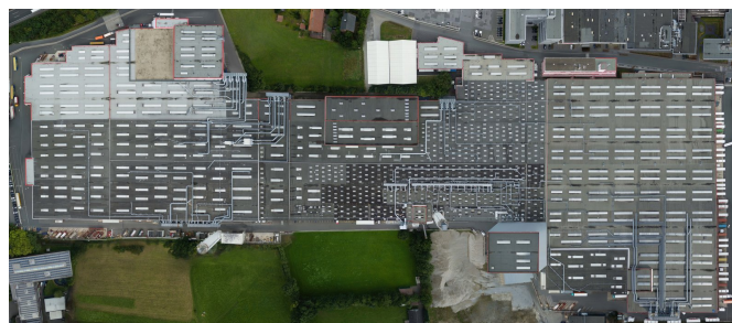
Baudokumentation für nobilia, Gütersloh (Fotografie): Werk 1 als Senkrecht-Luftaufnahme — Drohnenbefliegung nach Raster, aus den Einzelbildern zu einem rund 300 Megapixel großen Bild zusammengesetzt. Grundlage für Planung und Dokumentation eines Werksgeländes im Bestand. Rechts ein Ausschnitt aus derselben Aufnahme — er zeigt gut sechs Prozent der Bildfläche. Online lässt sich bis auf einzelne Dachaufbauten heranzoomen; der Code links führt direkt dorthin.
