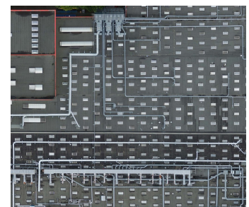
Baudokumentation für nobilia, Gütersloh (Fotografie): Werk 1 als Senkrecht-Luftaufnahme — Drohnenbefliegung nach Raster, aus den Einzelbildern zu einem rund 300 Megapixel großen Bild zusammengesetzt. Grundlage für Planung und Dokumentation eines Werksgeländes im Bestand. Rechts ein Ausschnitt aus derselben Aufnahme — er zeigt gut sechs Prozent der Bildfläche. Online lässt sich bis auf einzelne Dachaufbauten heranzoomen; der Code links führt direkt dorthin.
